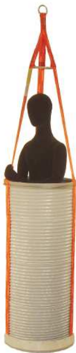
Fig. 10. Borsa/sacca diametro 50 cm, altezza borsa 120 cm, peso ca. 7 kg omologati per carichi fino a 120 kg PRODUTTORE euroline® marchio A. HABERKORN & CO. GMBH; Freistadt http://www.a-haberkorn.at/
